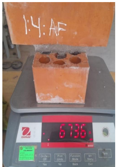
Figura 4 Espécimen de ladrillos cruzados sometido a ensayo de adherencia
