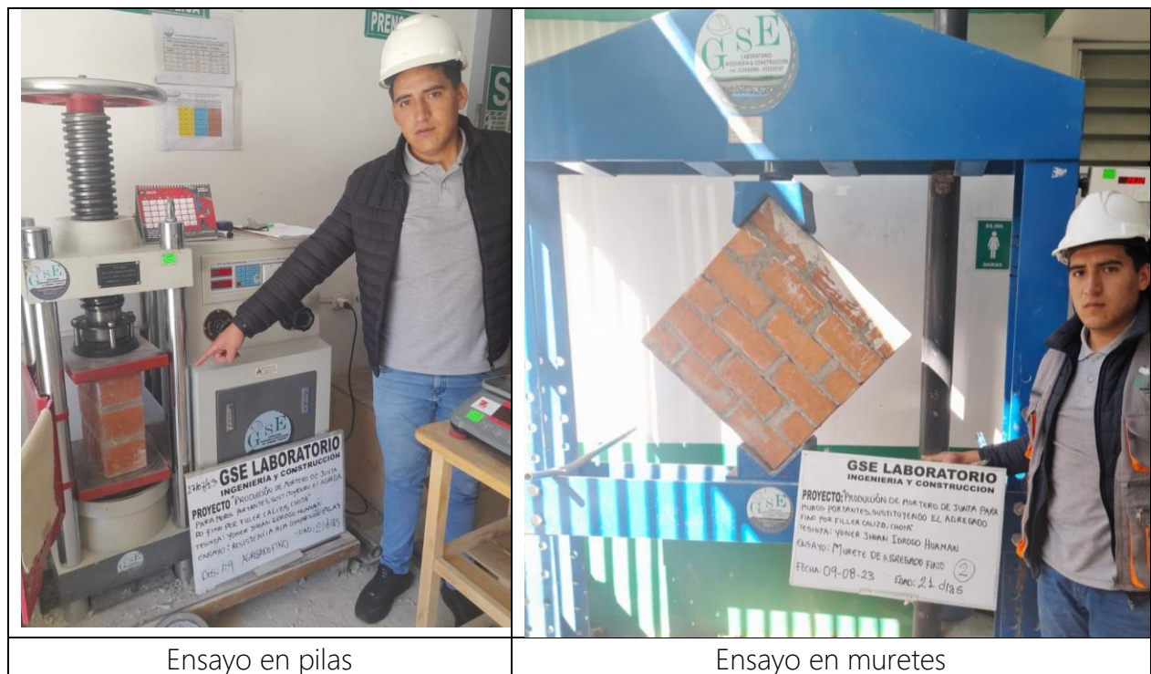
Figura 5 Ensayo en pilas y muretes de albañilería asentados con mortero cemento: arena o cemento: filler calizo según dosificación adecuada
