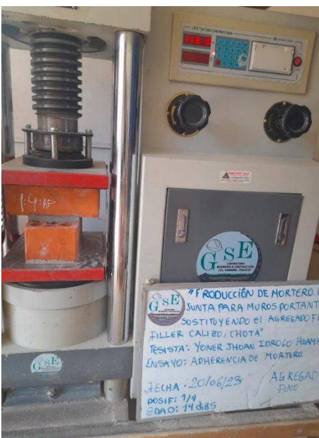
Figura 4 Espécimen de ladrillos cruzados sometido a ensayo de adherencia
