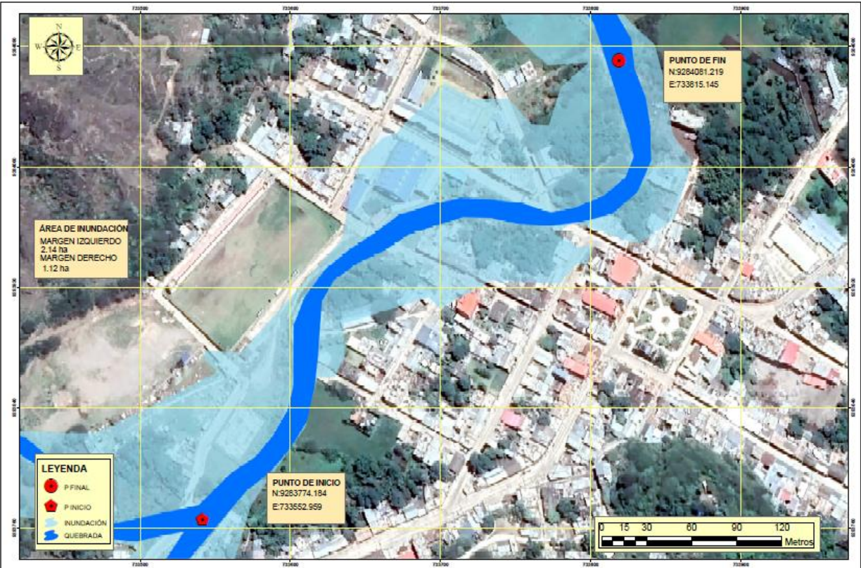
Figura 6. Áreas críticas con riesgo potencial a inundación por desborde la quebrada Machaypungo.
